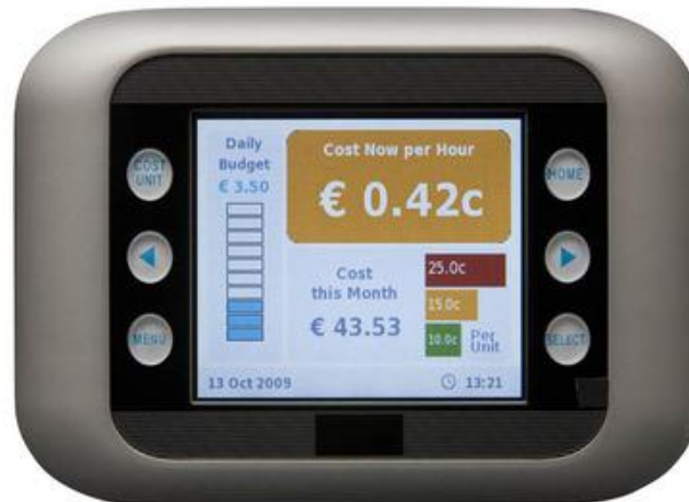
Figur 5 Smart elmåler der oplyser om elforbrug og omkostning i ”real time”
